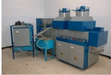
Установка МС-02М-3 для очистки (мойки), сушки и подсолки
